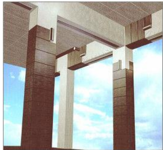
Figure IV : Principales applications industrielles de renforts composites selon la technique EBR (External Bonded Reinforcements) poteau (confinement), renfort de poutre en flexion, et à l'effort tranchant (doc SIKA)
