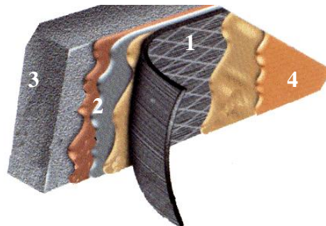
Figure III : Conception du système multicouche, (AFGC, 2003)
